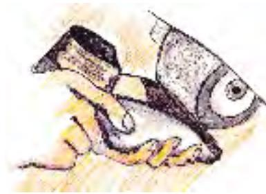
Nach Abschluss aller individuell auf den Kunden abgestimmten Fertigungsarbeiten stehen noch letzte Feinarbeiten aus. Hierbei bezeichnet man als Ausputzen das Bearbeiten von Sohlen und Absatzkanten durch Fräsen, Glätten und Polieren.
