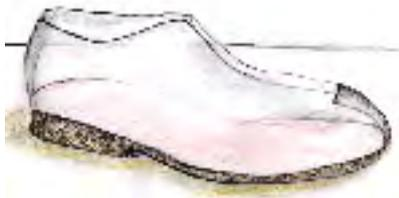
Zur Kontrolle der Passgenauigkeit wird mit Hilfe des individuell hergestellten Leistens ein aus transparenter Folie hergestelltes Gehprobenmodell (Probekleidung mit Klarsichtfolienschaft) erstellt. Auf diese Weise ist es möglich, eventuell nötige Korrekturen zu erkennen und bei der Schuhfertigung entsprechend zu berücksichtigen. Des Weiteren bespricht der Orthopädienschuhmacher zusammen mit dem Kunden das Schaftmodell.
