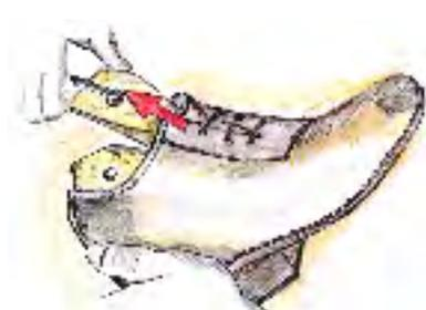
Nach dem Ausputzen wird der formgebende Leisten mit Hilfe eines Leistenhakens aus dem fertigen Schuh gezogen (Fachausdruck: ausgeleitet). Dieses muss unter besonderer Sorgfalt geschehen, da sonst der Schuh am Ende des Fertigungsprozesses noch beschädigt werden kann.
