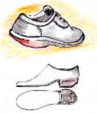
Das normale harte Aufsetzen des Fußes in der ersten Phase der Schritt- abwicklung ist aufgrund des Fersenaufsetzens oftmals sehr unangenehm für den Kunden. Das Abrunden der hinteren Kante des Absatzes (Abrollabsatz) parallel zur Auftrittsfläche hat eine Verkürzung des hinteren Fußhebels zur Wirkung und bewirkt somit eine geringere Beanspruchung des oberen Sprunggelenks beim Fersenauftritt, wodurch die Schrittabwicklung des Kunden erleichtert wird und Gelenke geschont werden.
