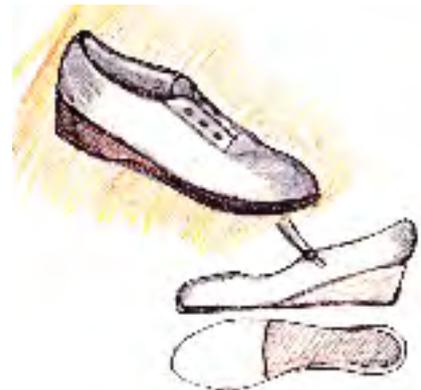
Der Keilabsatz geht vom Ballen bis zur Ferse und verstärkt somit die gesamte Gelenkpartie des Schuhs. Mit dem Keilabsatz ist es möglich, den Schuh fester und steifer (durch die Verwendung fester Werkstoffe wie z. B. Leder oder Holz) sowie federnd (durch die Ver-
